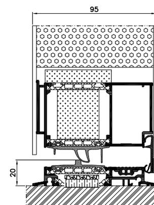
Alle im Angebot erhältlichen Modelle können durch Einsetzen zwischen zwei Profilen oder durch einseitiges oder doppelseitiges Kleben an den Profilen befestigt werden.
